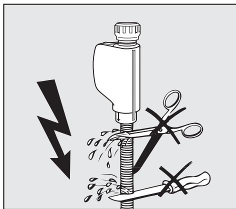
**⚠ No acorte o dañe la manguera de entrada de agua, ya que en su interior hay componentes eléctricos (véase fig.).**
