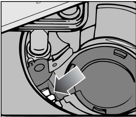
La bomba de desagüe se encuentra bajo la válvula antirretroceso (flecha).
